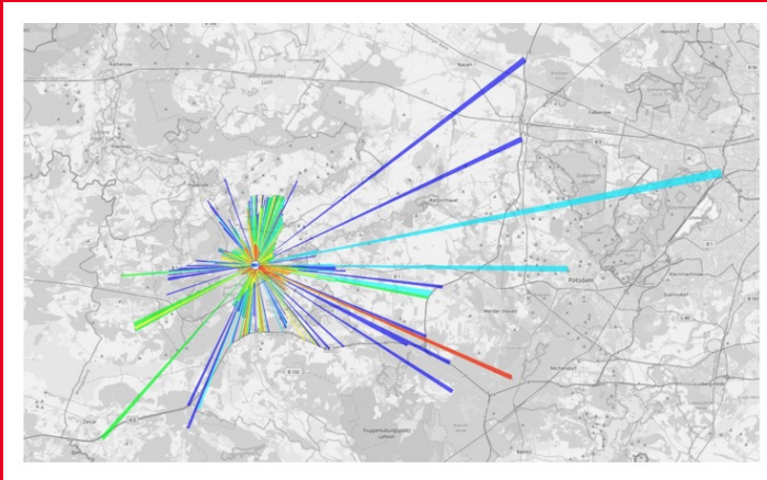
Darstellung der Reichweite eines LoRaWAN-Gateways auf einem Berg
